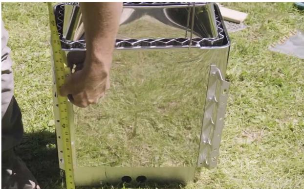
Mesurez la hauteur des trous de montage et ajoutez 6". (152 mm)
