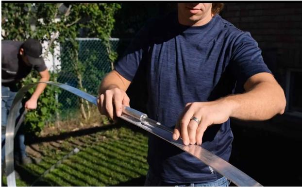
Pré-assembler 2 des bandes et visser l'écrou juste assez pour les maintenir ensemble.
